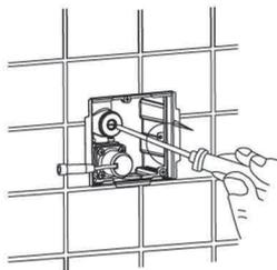
2. Вращайте против часовой стрелки шестигранный ключ S 10 и снимите крышку фильтра
