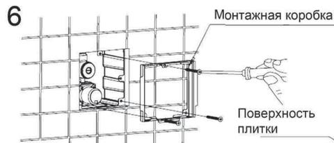
После удаления защитного корпуса, установите монтажный короб в внутренний корпус, как показано на схеме, затем закрутите три крепежных винта.
