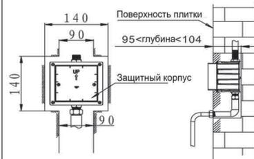
Размеры внутреннего корпуса и внутренней Г-образной трубы
