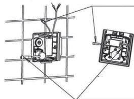
Водозащищенный провод (черный) электромагнитного клапана
