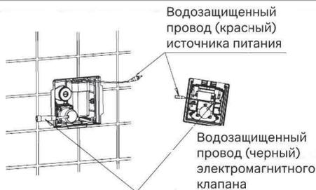
Соедините провод питания (красный) и провод электромагнитного клапана (черный) соответственно заземления на датчике. (Цвета проводов должны соответствовать друг другу)
