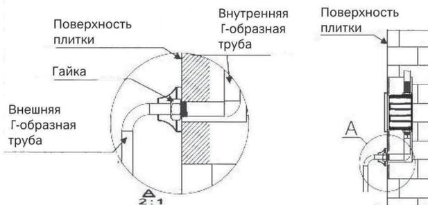
Предложение: Выведите резьбу на внутренней Г-образной трубе на 12мм выше, чем поверхность плитки для удобства монтажа и перемещения внешней Г-образной трубы, и внешних соединений.
